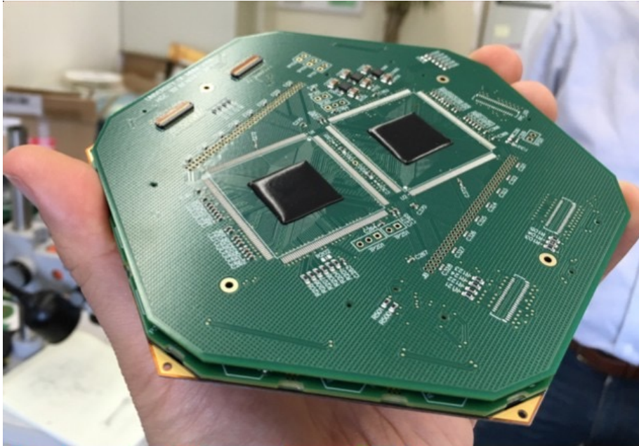
Figure 3 : Exemple de module complet utilisé lors des tests en faisceaux au Fermilab en 2016. En noir sont visibles deux ASICs ( Application-Specific Integrated Circuits ) SKIROC2_CMS développés par OMEGA.
